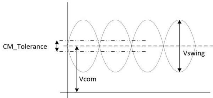
**Figure 1-1. Common-Mode Tolerance**
