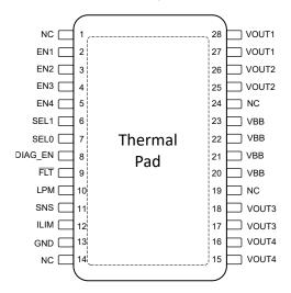
Figure 4-1. Pin Diagram
