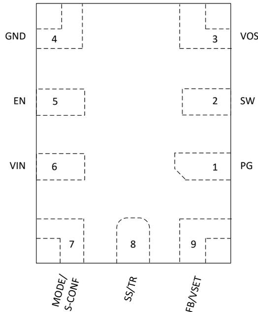
**Figure 3-1. Pin Diagram**
