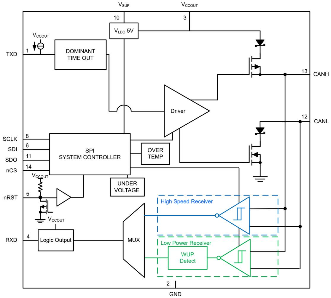
Figure 5-1. TCAN1164-Q1 and TCAN1164T-Q1 Block Diagram
