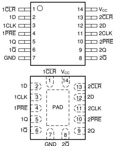
**Figure 4-1. Pin Diagram**
