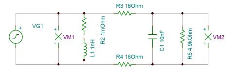
Figure 3-6. Input Filter TINA-TI
