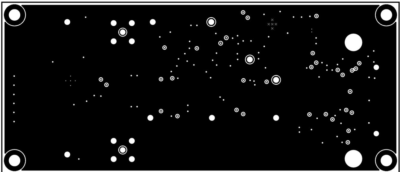
Figure 14. REF6025EVM PCB Layer 2: GND Plane
