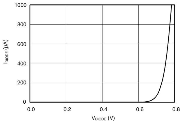
**Figure 1.  $I_{\text{DIODE}}$  vs  $V_{\text{DIODE}}$**
