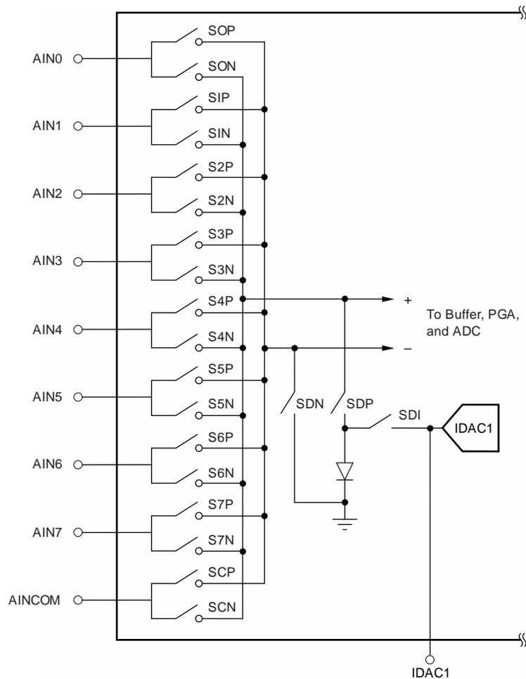
**Figure 4. Block Diagram of ADS1216 Input Circuitry**
