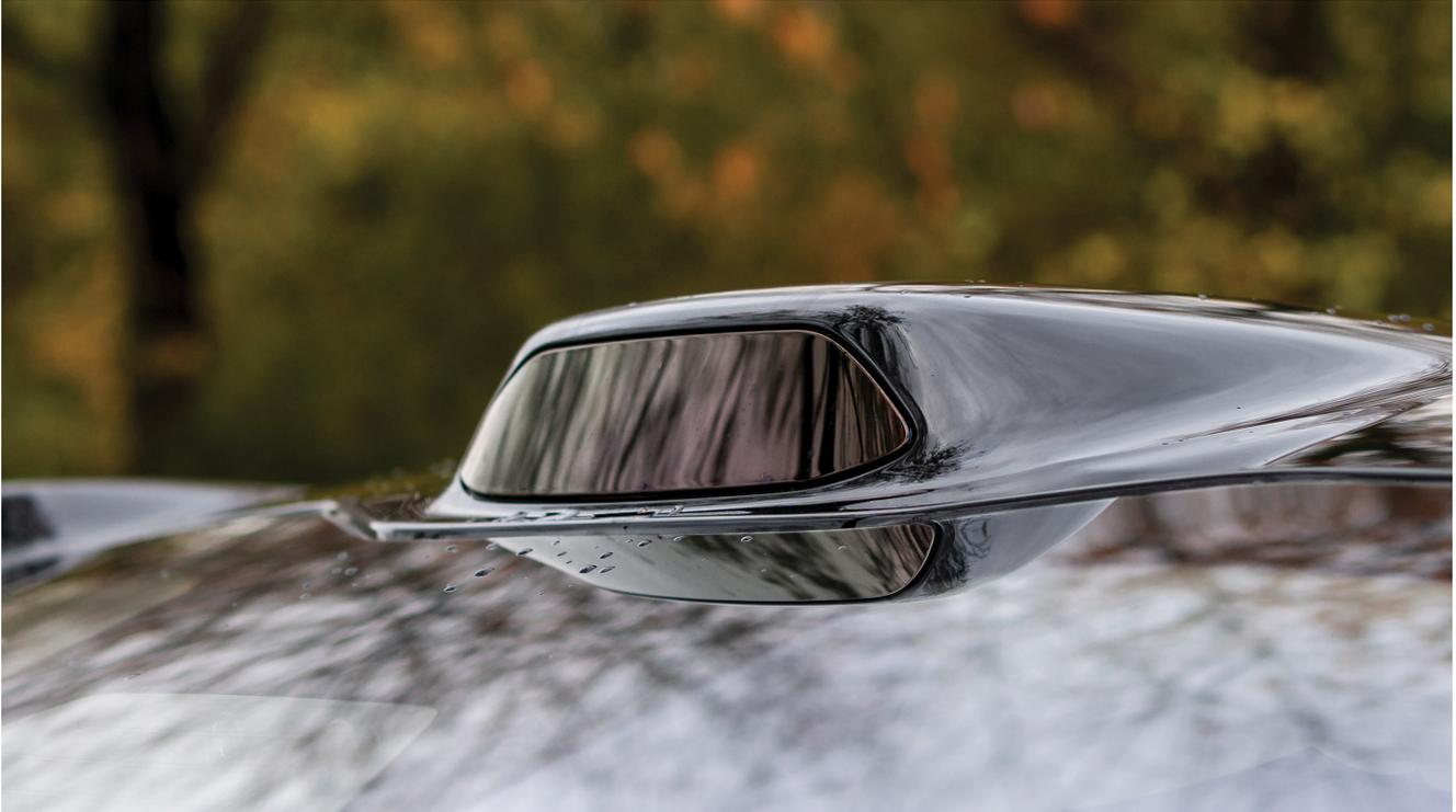
**그림 2. 차량 상단에 장착된 LiDAR 모듈**
