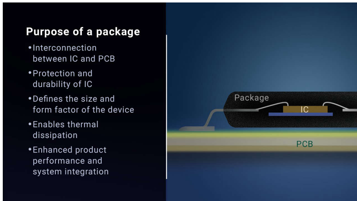
図 1. 代表的なアナログパッケージの内部図と、達成されるパッケージ
