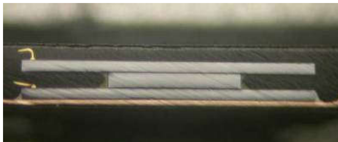
図 20. シリコンスタッキングにより密度を向上したマルチチップアナログフロントエンドパッケージ。
