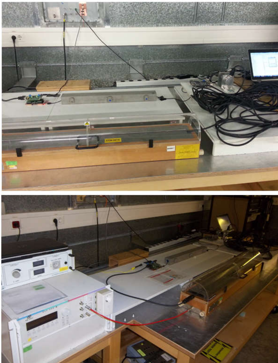
図 7-39. TIDA-00176 の IEC61000-4-4 EFT テスト設定 (右側は上側、左側は下側)
