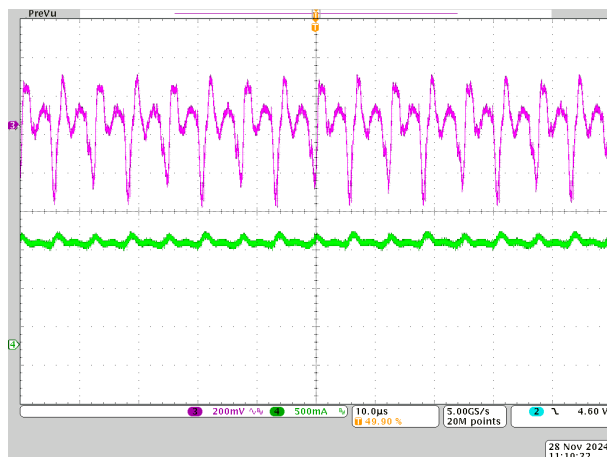
図 4-19. 80kHz PWM、10A での電解コンデンサのリップル電流およびリップル電圧
