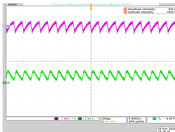
図 4-20. 8kHz PWM、10A でのセラミックコンデンサのリップル電流およびリップル電圧
