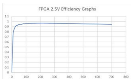
図 4-3. 2.5V での FPGA 効率
