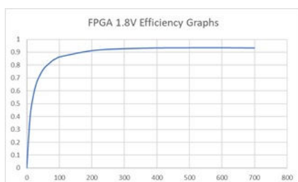
図 4-5. 1.8V での FPGA 効率
