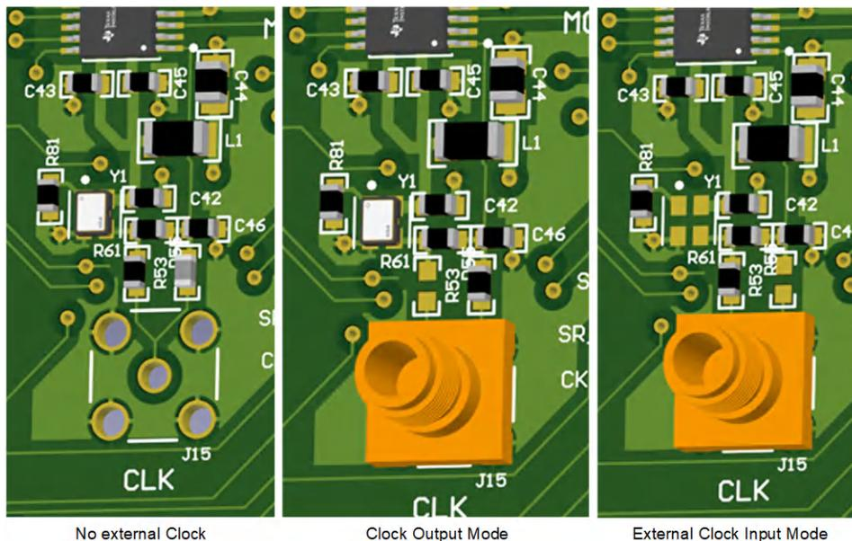
図 4-6. Clocking Assembly Variants
