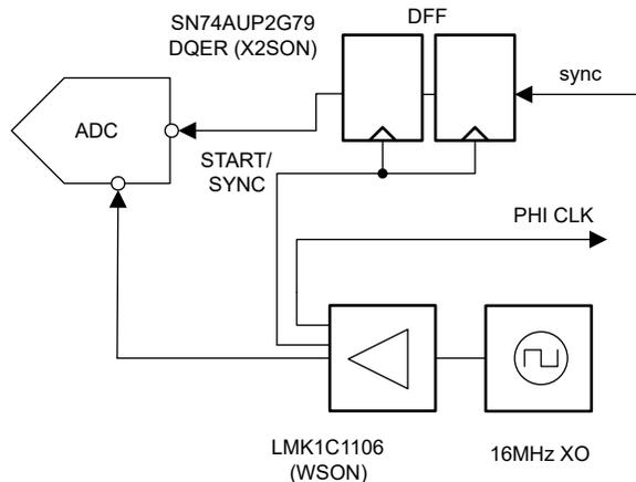
図 2-3. ADC Synchronization Circuit
