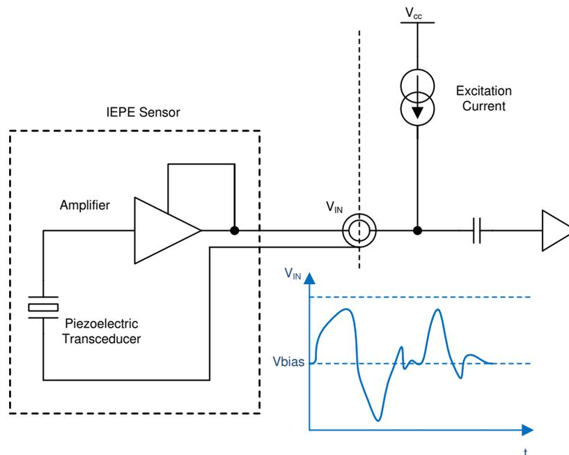
図 3-1. IEPE Sensor Conceptual Circuit
