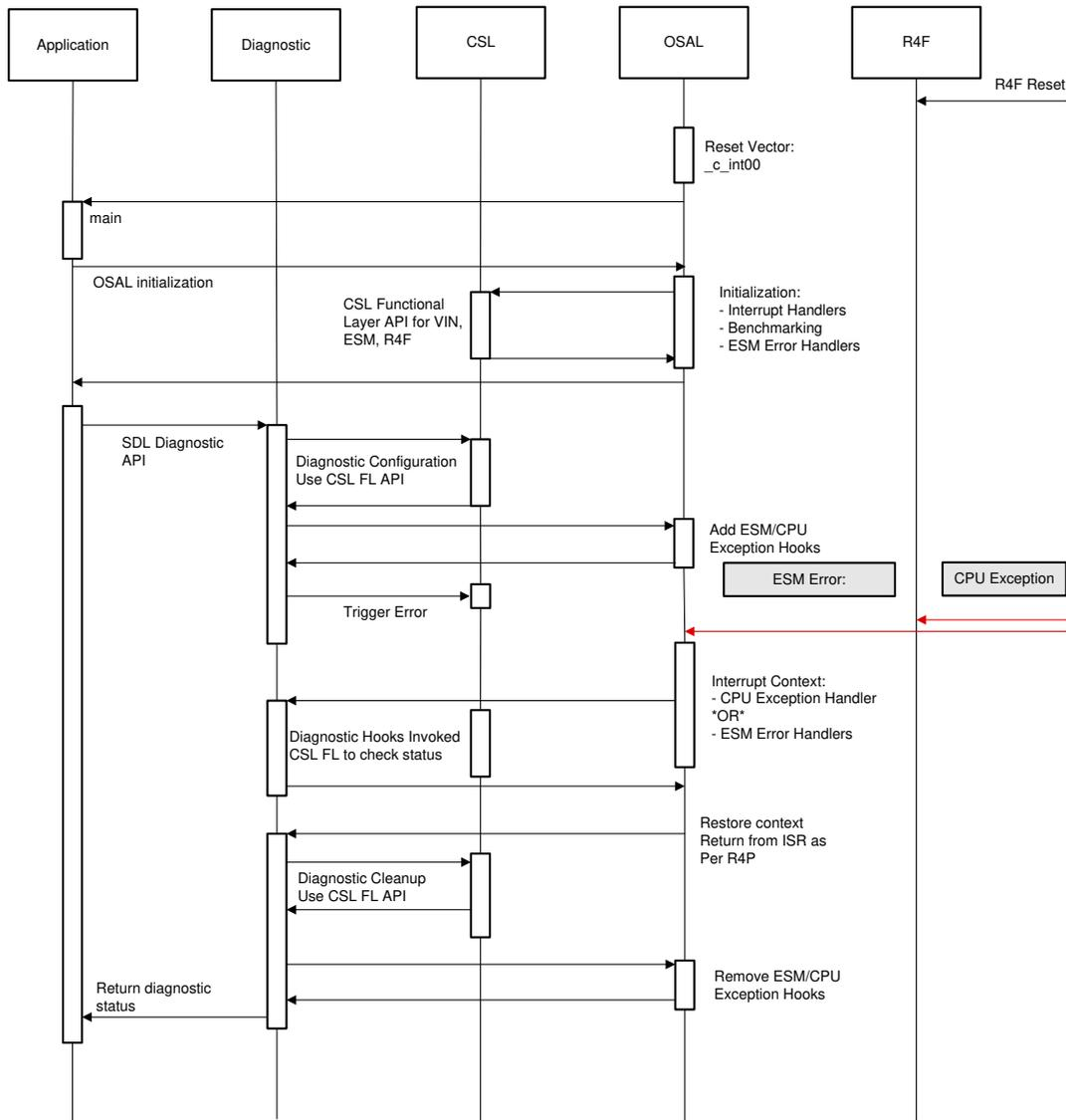
图 2-10. DIAG Test Flow
