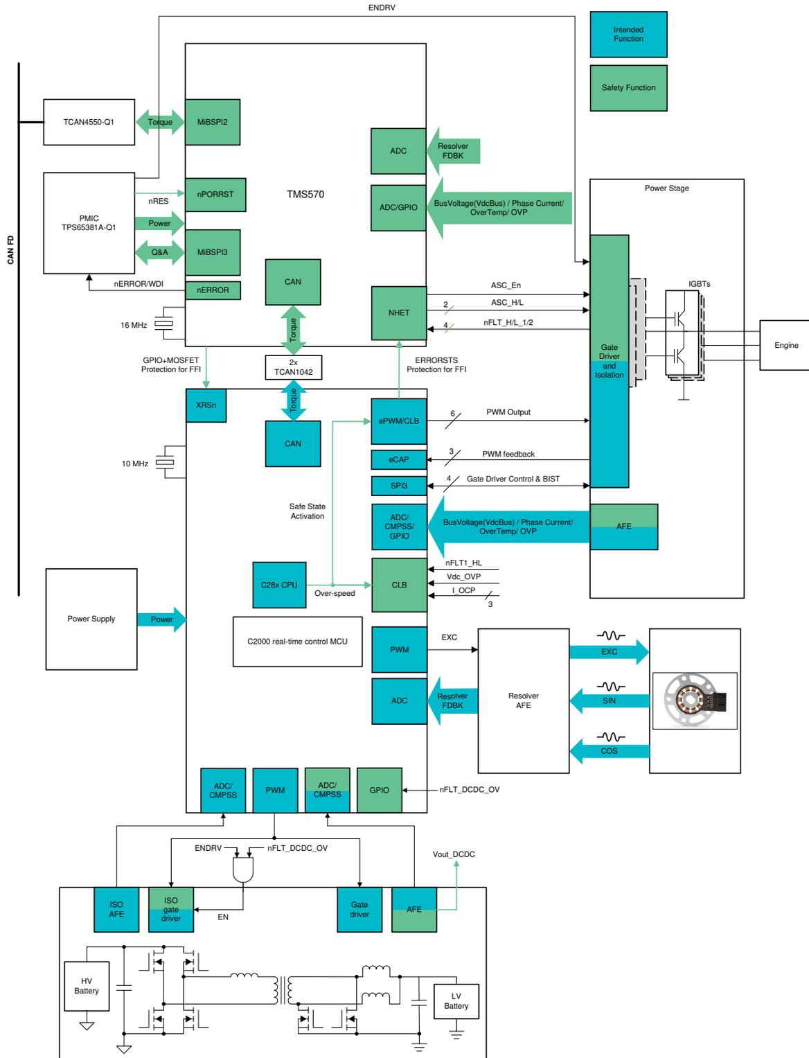
図 2-1. TIDM-02009 Block Diagram
