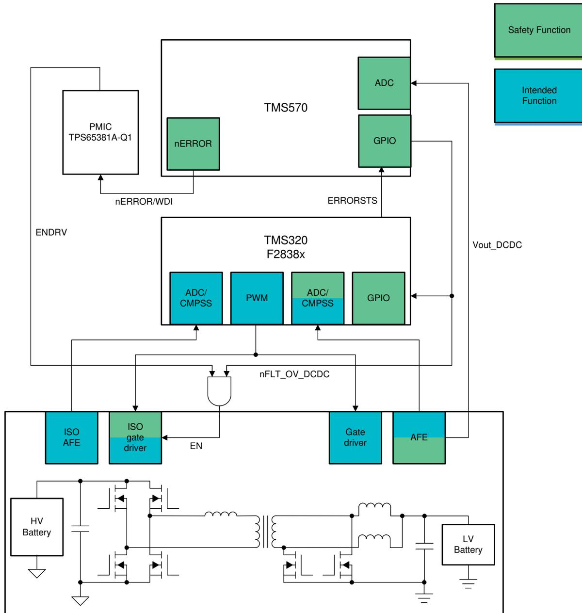
図 3-26. DC-DC System Block Diagram
