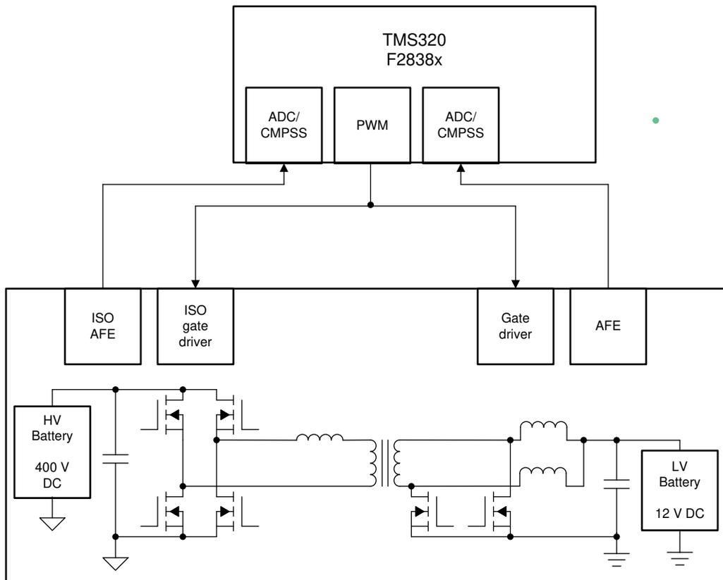
図 1-3. DC-DC System Block Diagram
