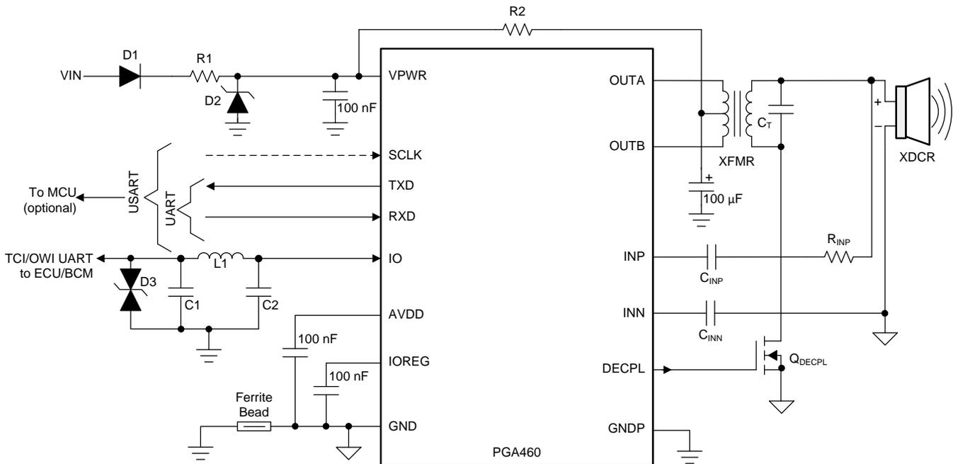
図 3. TIDA-060024 Block Diagram
