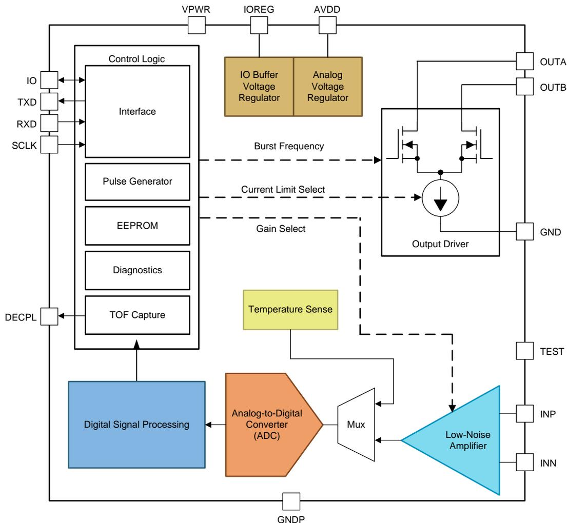
図 10. PGA460 Block Diagram
