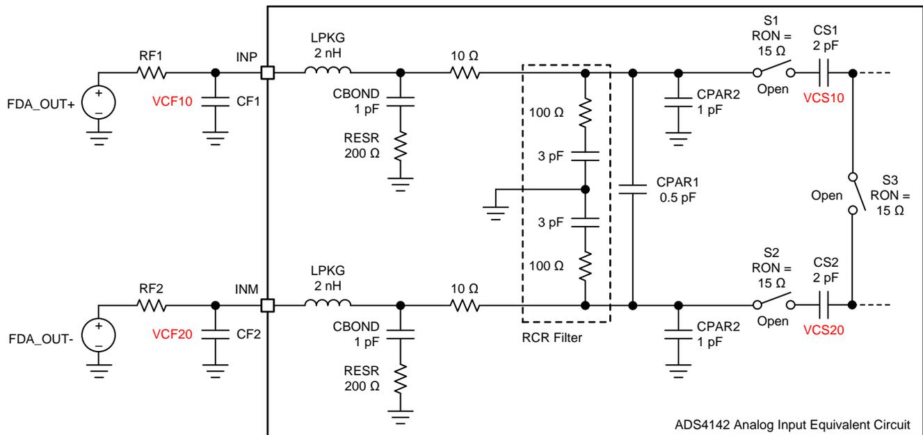
図 13. ADS4142 Analog Equivalent Circuit
