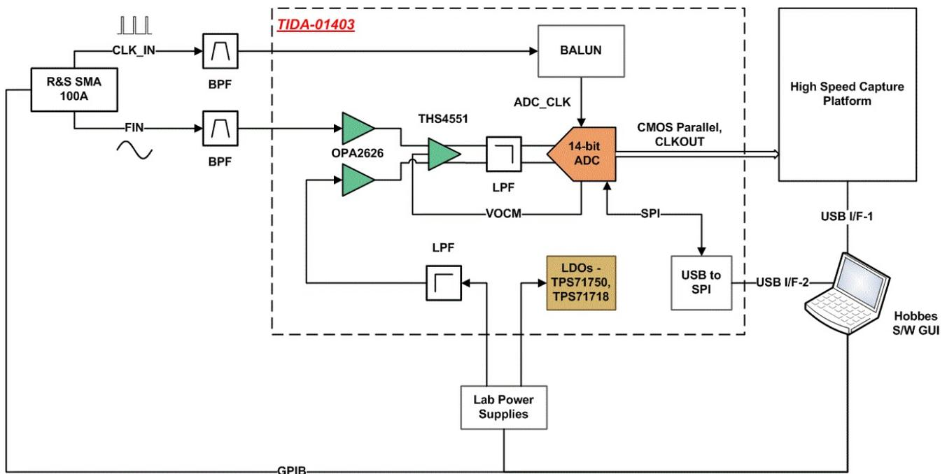
図 25. TIDA-01403 Test Setup
