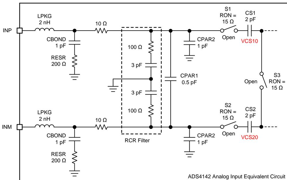
図 11. ADS4142 Analog Equivalent Circuit
