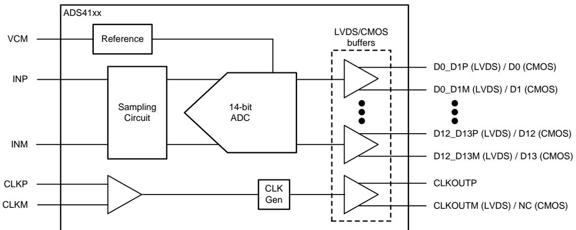
図 1. ADS41xx Block Diagram
