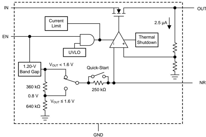
図 4. TPS717xx Functional Block Diagram
