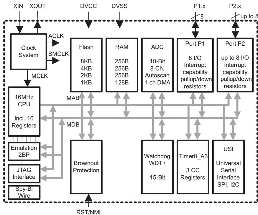
図 10. MSP430G2332 Functional Block Diagram
