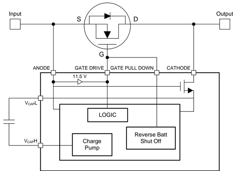
図 7. LM74610-Q1 Functional Block Diagram
