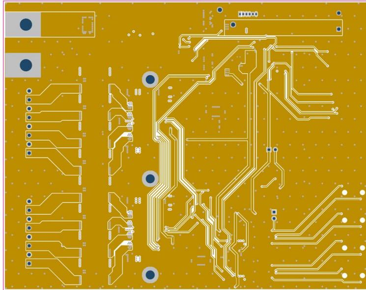
図 44. TIDA-00733 Circuit Board—Inner Layer 2
