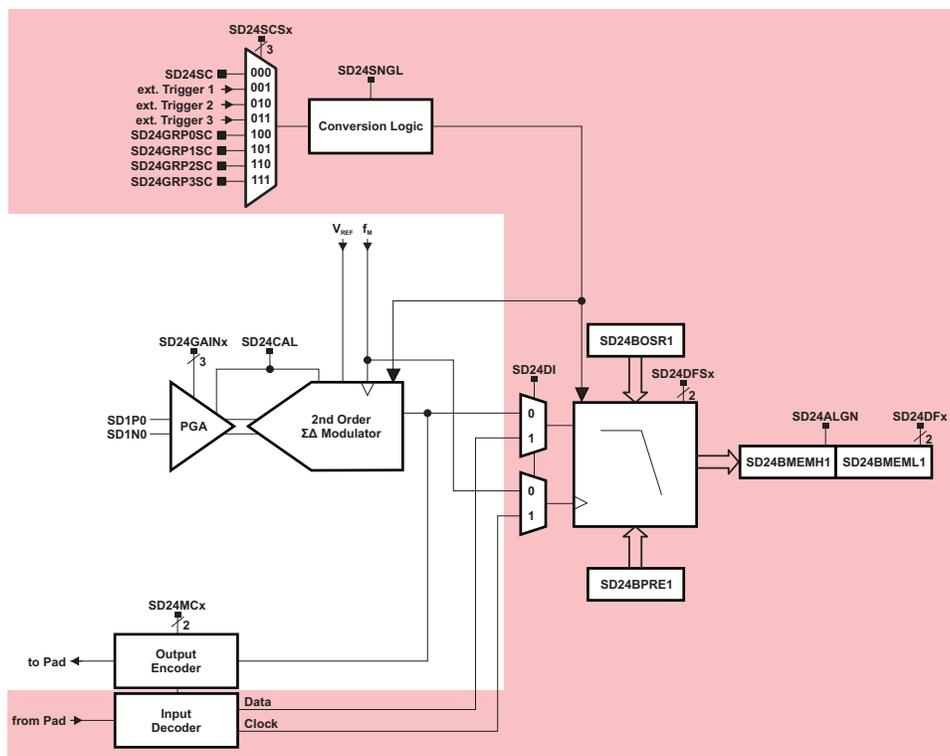
図 3. SD24\_B Converter Block Diagram
