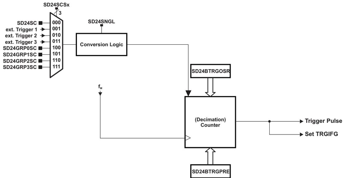
図 4. SD24\_B Trigger Generator Block Diagram
