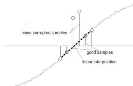
図 16. Frequency Measurement
