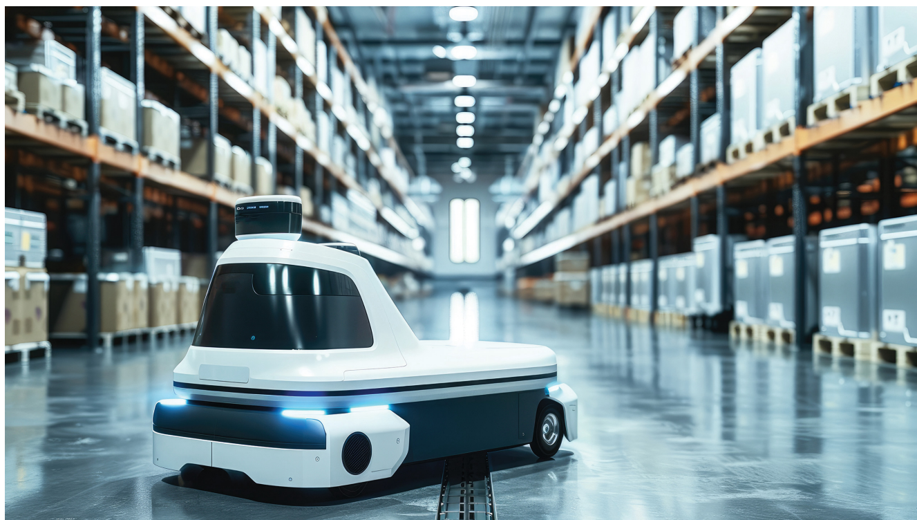
図 1. LiDAR を使用してナビゲーションを行う AMR
