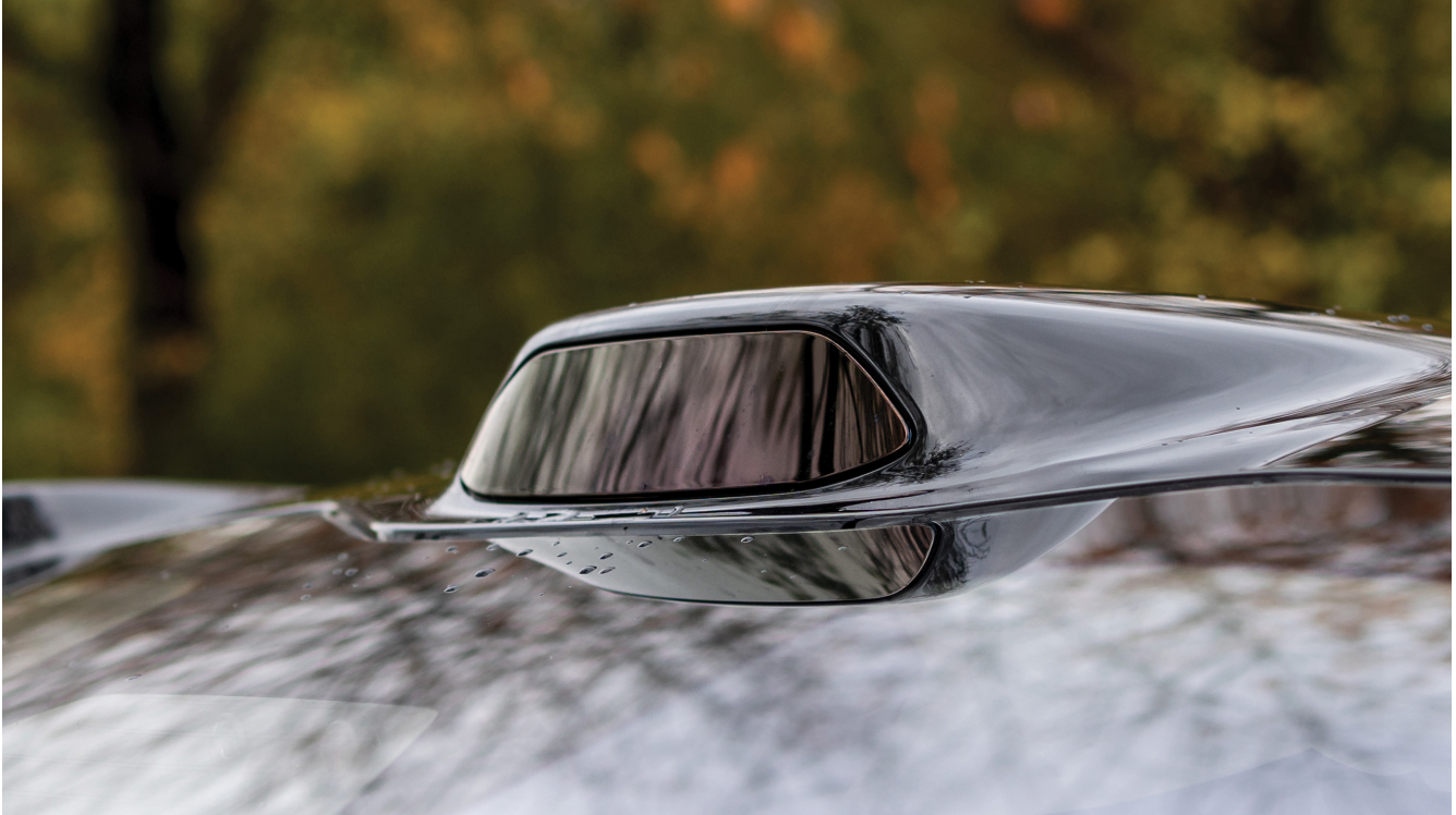
図 2. 自動車の上部に搭載されている LiDAR モジュール
