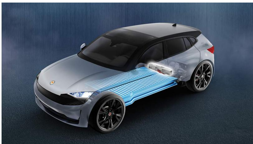
図 1. EV で使用する代表的な BMS とバッテリー
