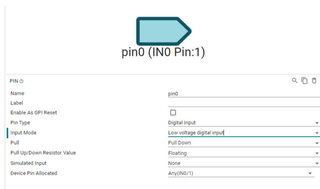
図 2. 低電圧デジタル入力を示す ICS ピン設定
