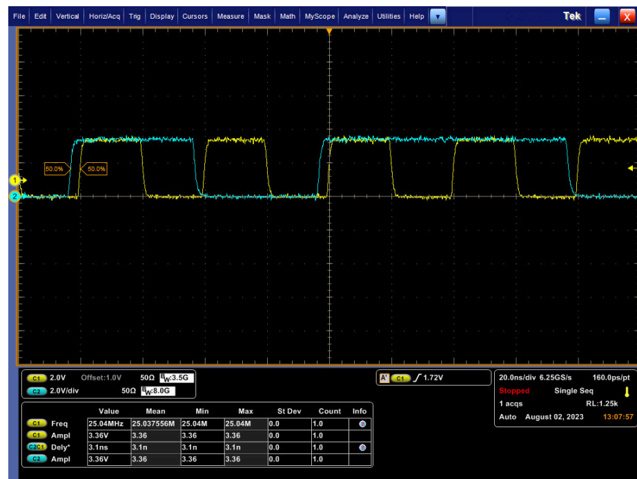
図 2-21. RGMII RX シフトモードにおける RX_CLK と RX_D0 のタイミング (黄色の波形 (チャンネル 1) = RX_CLK、青色の波形 (チャンネル 2) = RX_D0)
