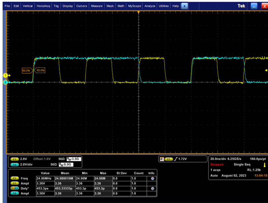
図 2-20. RGMII アラインモードにおける RX_CLK と RX_D0 のタイミング (黄色の波形 (チャンネル 1) = RX_CLK、青色の波形 (チャンネル 2) = RX_D0)
