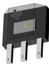
図 2-2. TMAG5213ADQLPG、ホール効果素子を強調表示したピン配置
