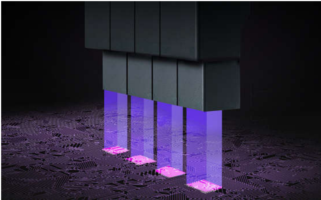
図 1. DLP DMD を使用するマスクレス フォトリソグラフィー
