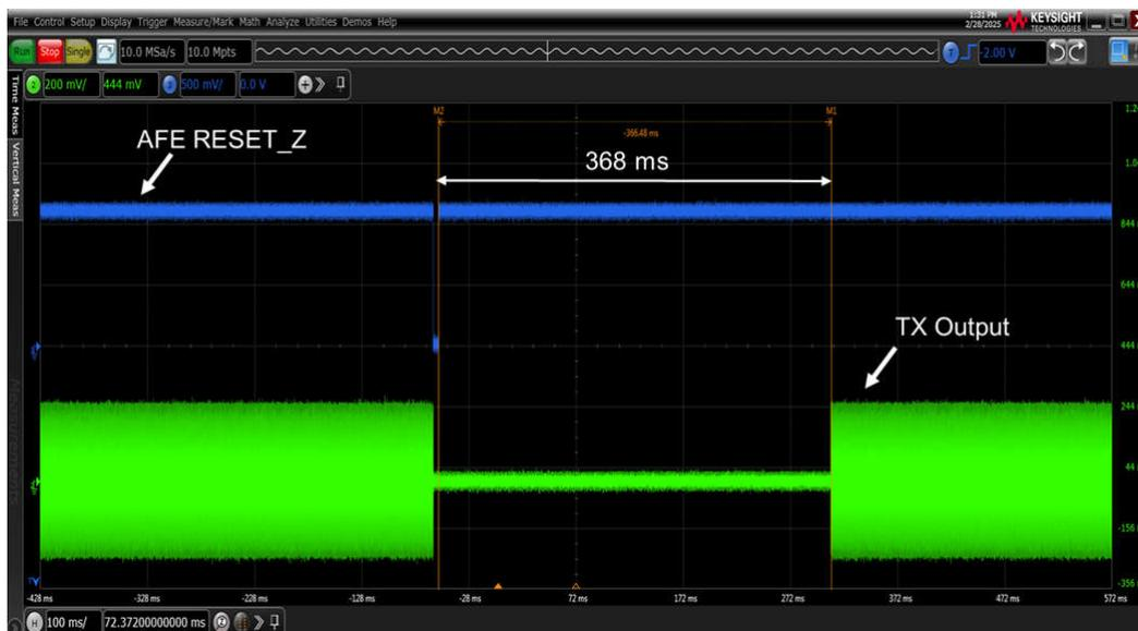
図 8-1. スコープで測定された起動時間
