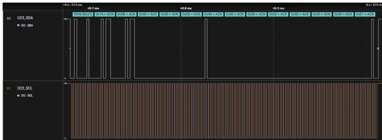
図 4-3. 割り込みマスクレジスタ、0x16 の設定
