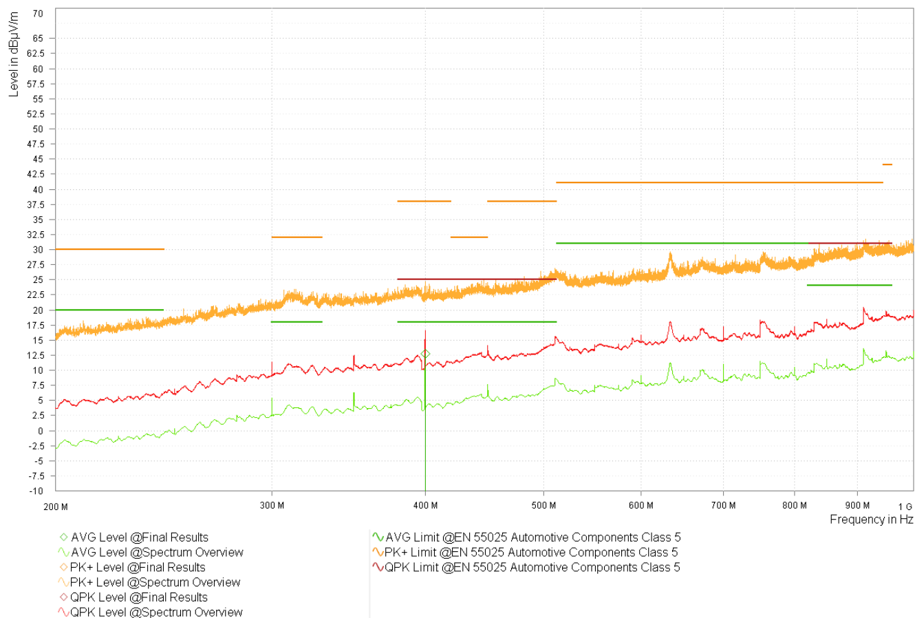
図 3-17. バリエント 1 LMK3H0102-Q1 1.8V スペクトラムの概要 - 対数周期
