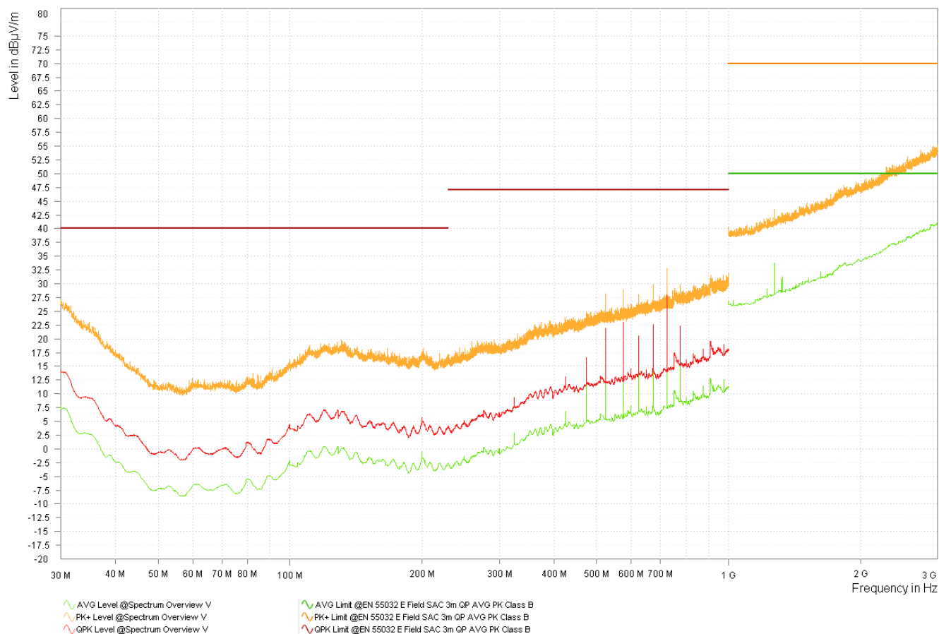
図 4-7. バリエント 3 LMK3H0102 3.3V Y 軸スペクトルの概要 - 垂直
