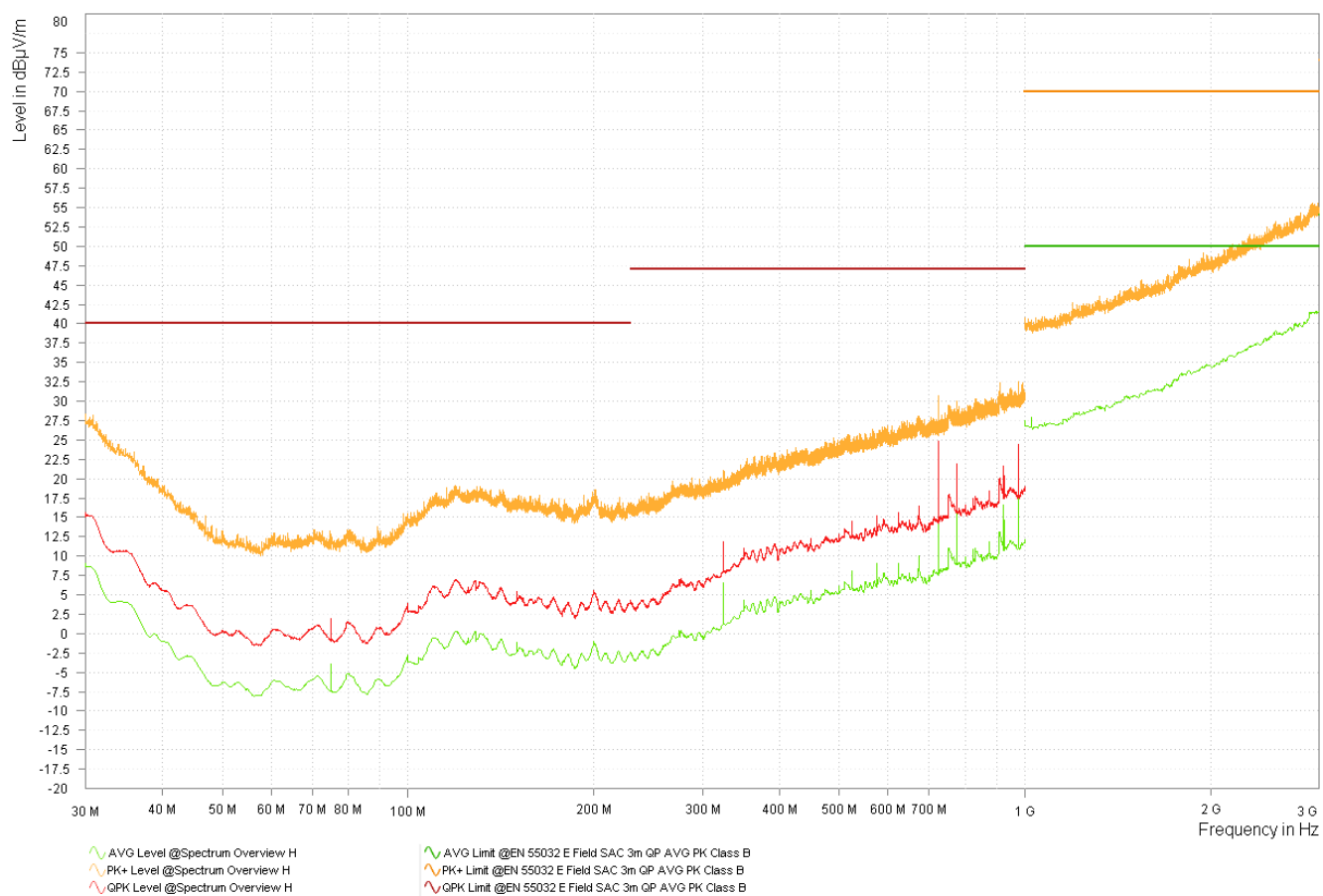
図 4-6. バリエント 3 LMK3H0102-Q1 3.3V Y 軸スペクトルの概要 - 水平
