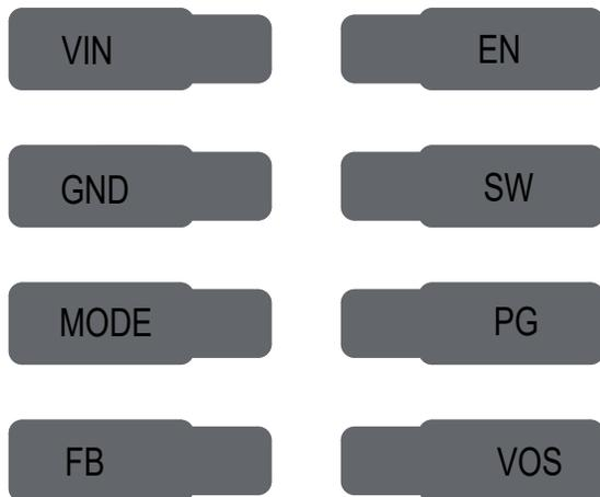
図 8. オーバーラップした QFN と SOT583 のフットプリント
