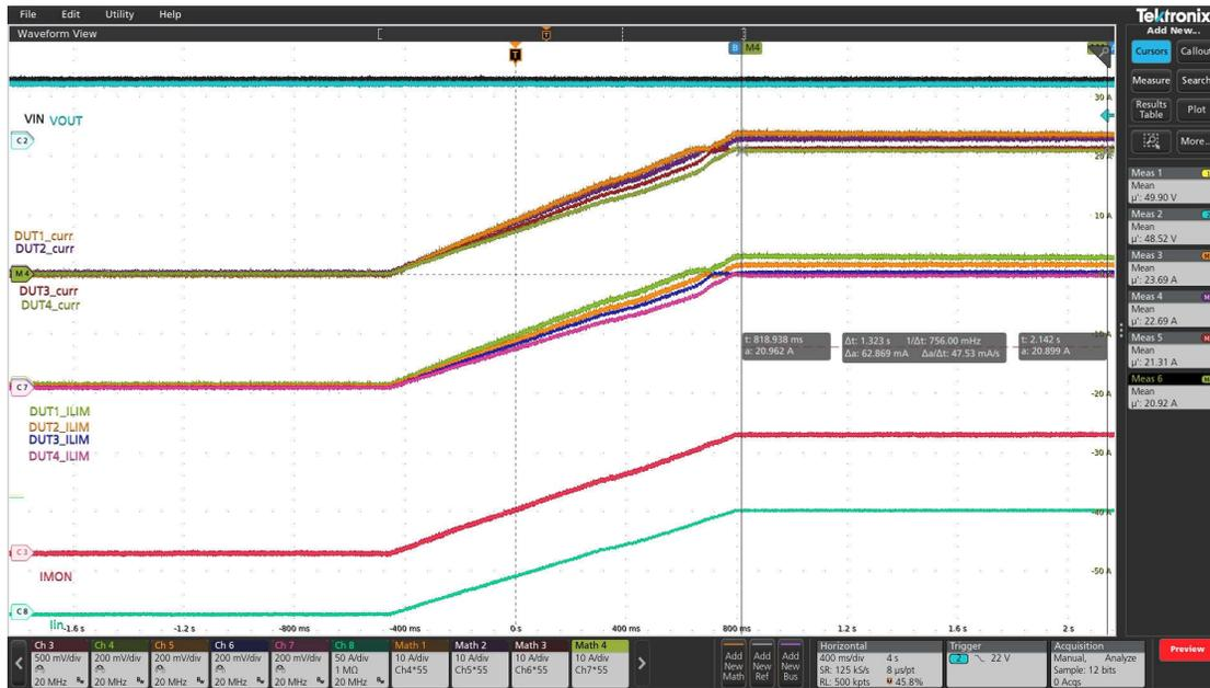
図 3-3. ACS 非使用時における 4 個の eFuse 間の電流分担
