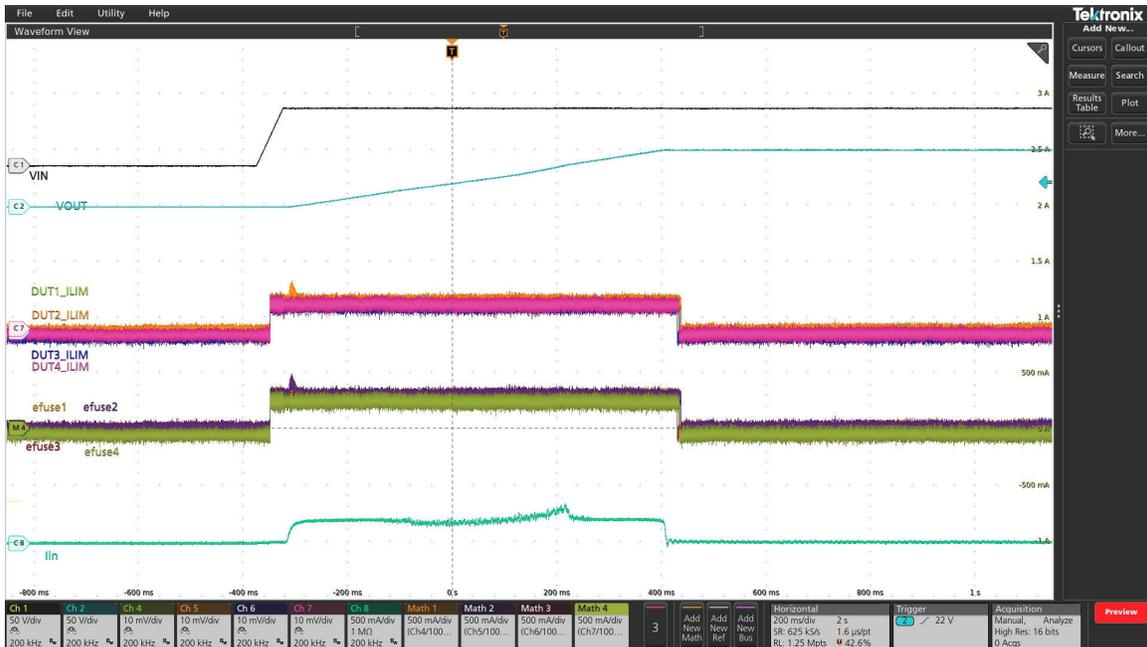
図 3-6. 起動時における 4 個の TPS1685 eFuse 間の電流分布
