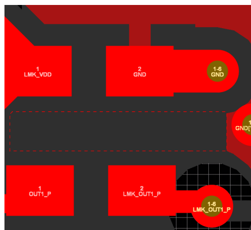
図 4-2. グラウンドフィンガーの除去
