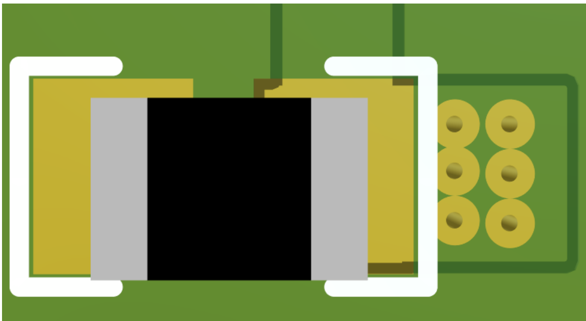
図 3-9. ビアが多い大きな受動部品
