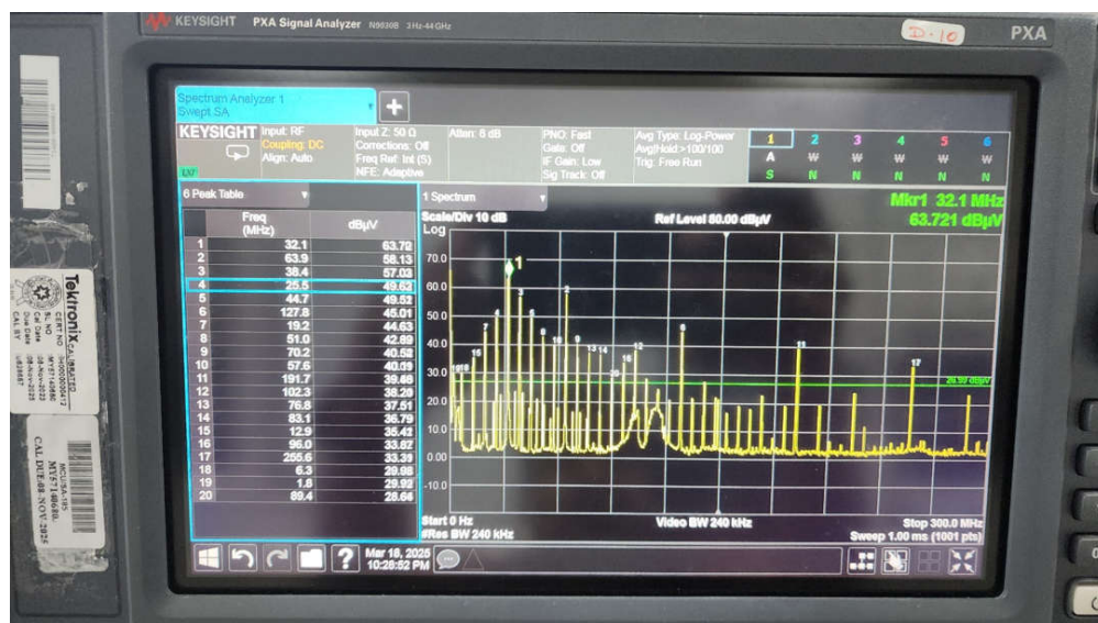
図 6-5. MSPM0L 上の Vcore での伝導ノイズ
