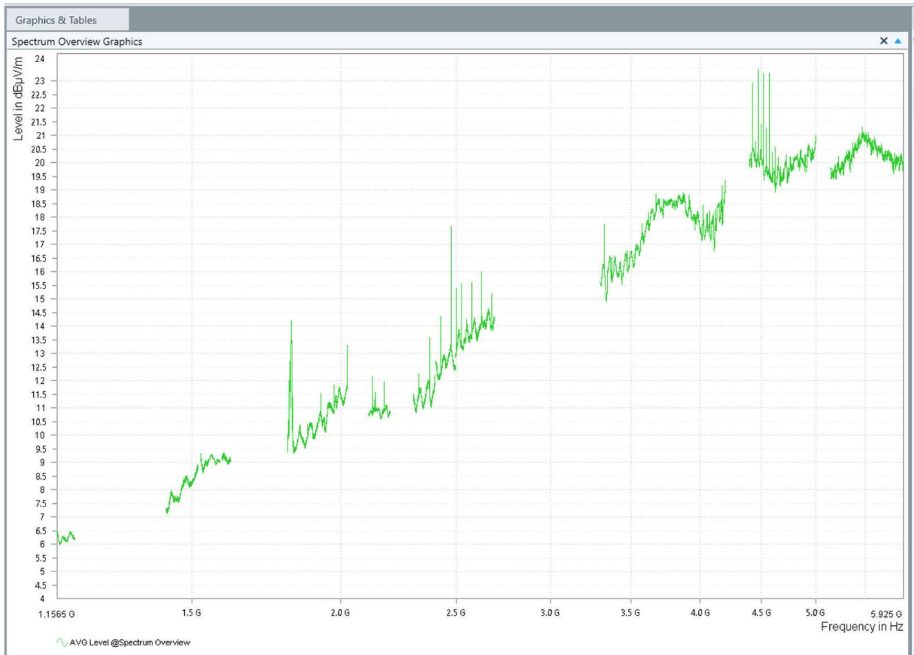
図 3-12. バリエーション 2 DLY - 3.3V - 水平スペクトル概要 - ホーン
