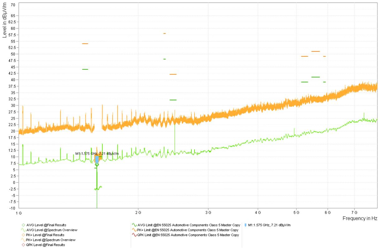
図 3-26. バリエント 3 LMK3C0105 1.8V (-0.5% SSC) スペクトラムの概要 - ホーン
