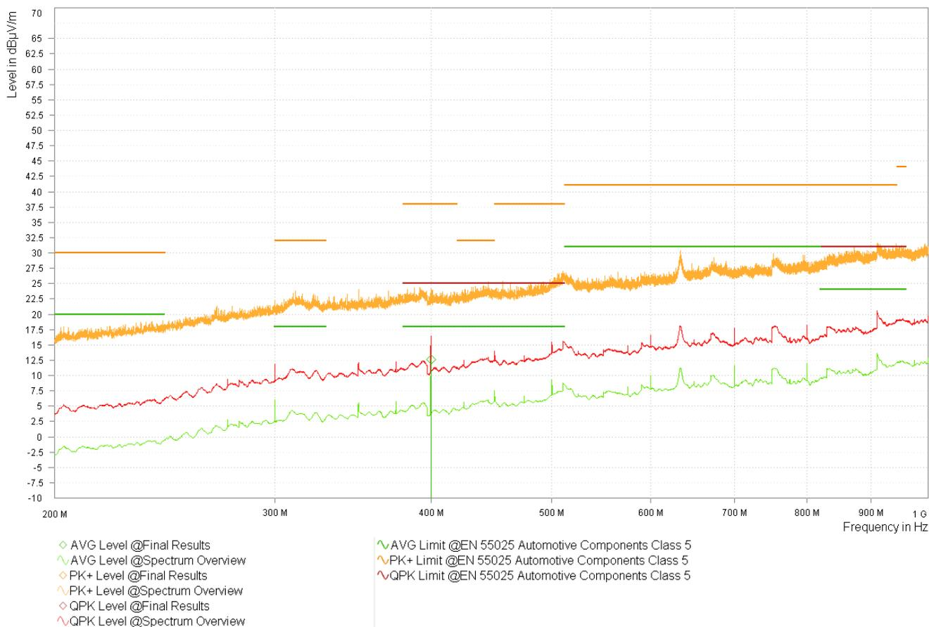
図 3-14. バリエーション 2 LMK3C0105 3.3V スペクトラムの概要 - 対数周期
