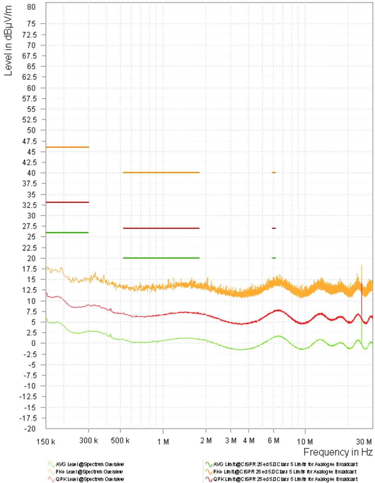
図 3-9. バリエント 3 LMK3C0105 1.8V スペクトラムの概要 - モノポール
