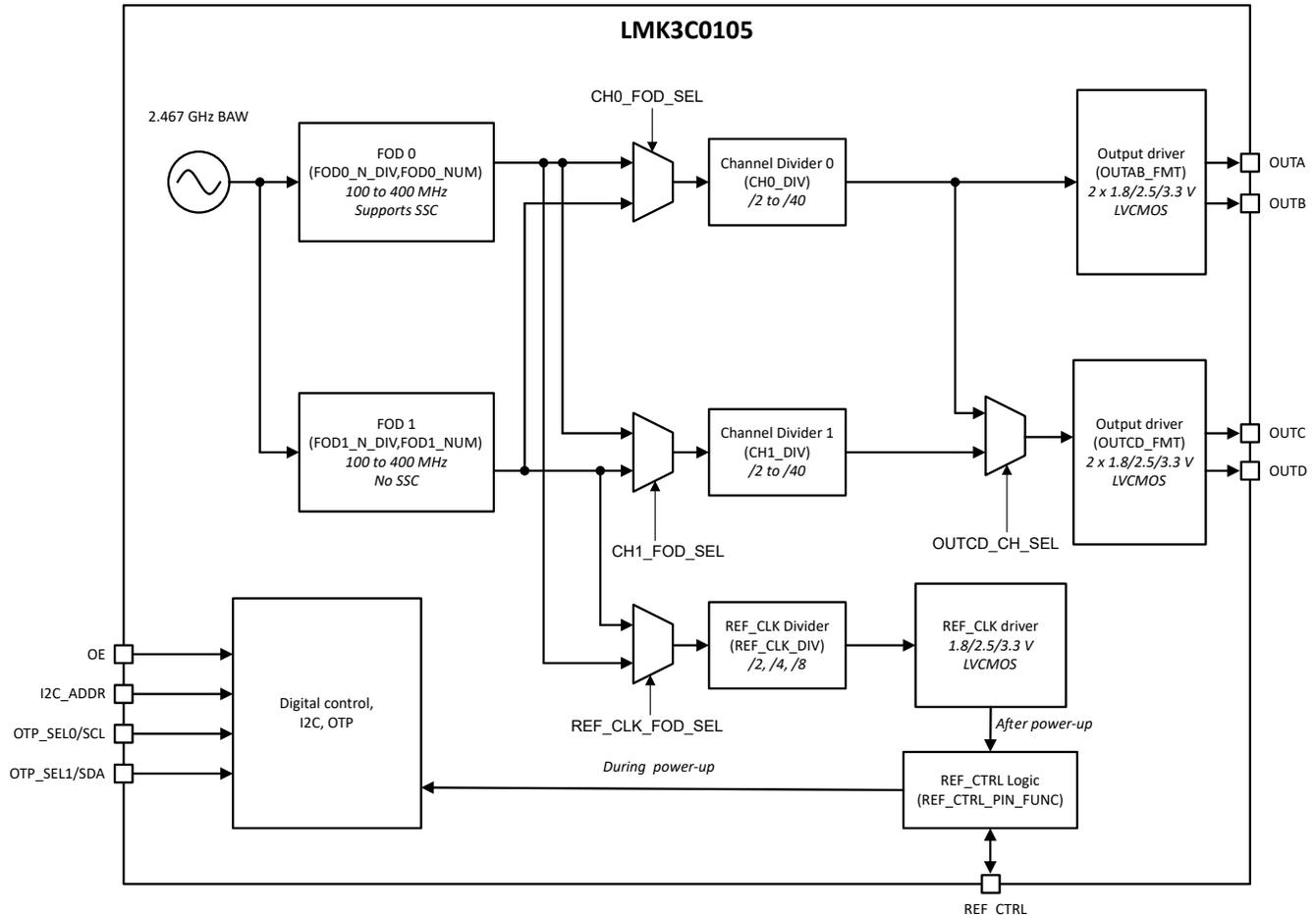
図 1-1. LMK3C0105 の機能ブロック図
