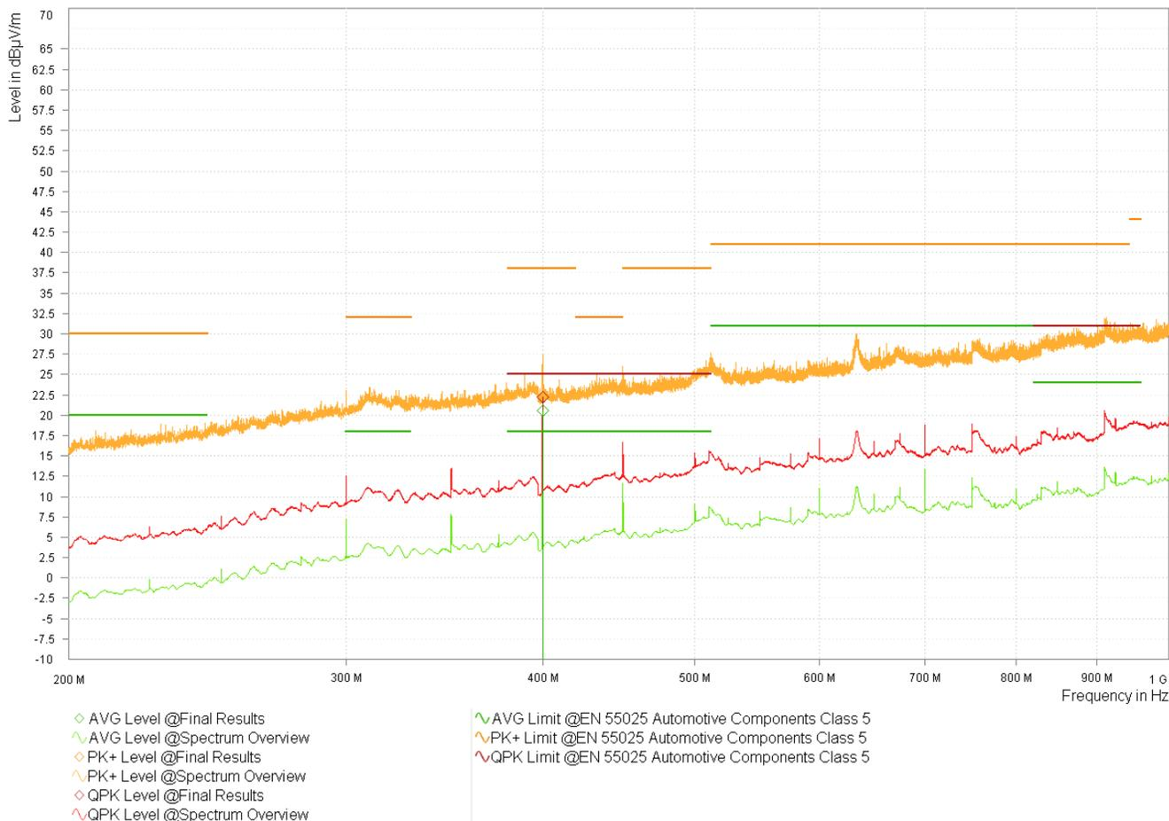
図 3-13. バリエーション 1 LMK3C0105 3.3V スペクトラムの概要 - 対数周期
