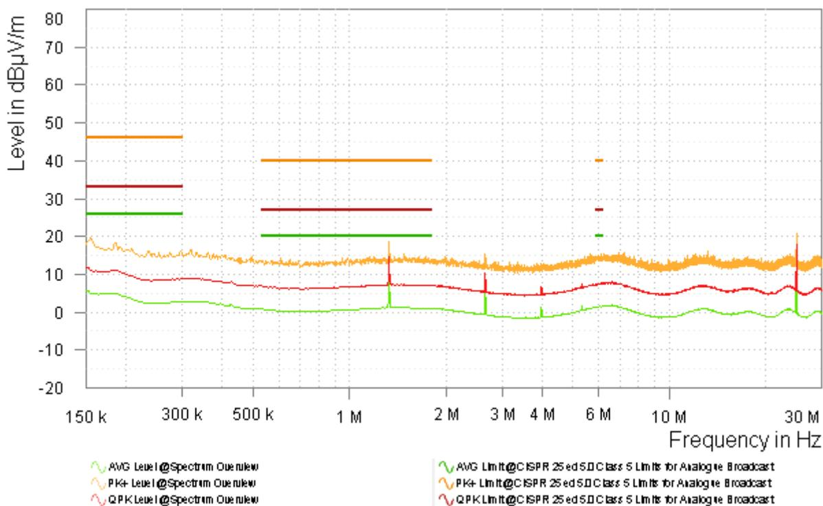
図 3-7. バリエーション 3 LMK3C0105 3.3V スペクトラムの概要 - モノポール
