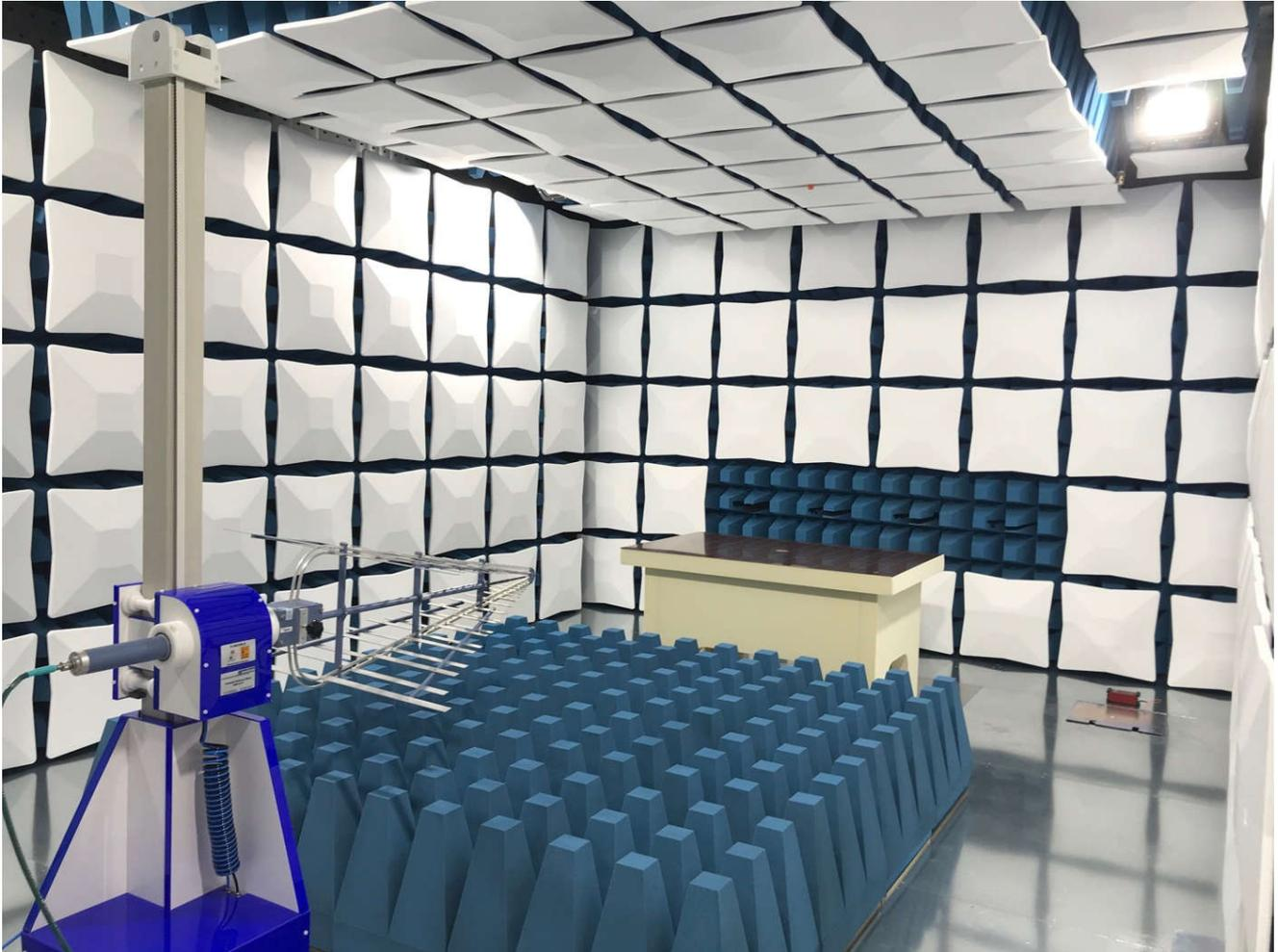
図 4-1. CISPR-32 のテストチャンパー設定
