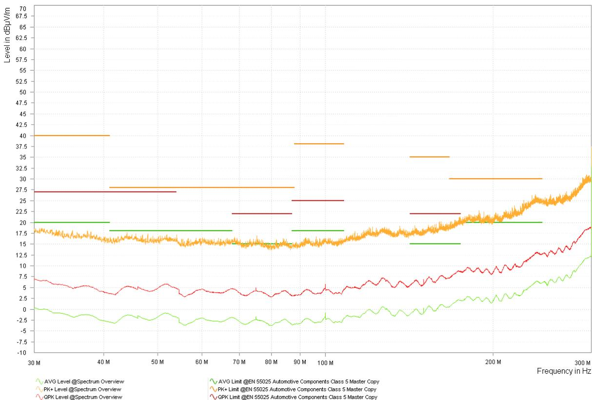
図 3-11. バリエーション 3 LMK3C0105 3.3V スペクトラムの概要 - バイコンカル
