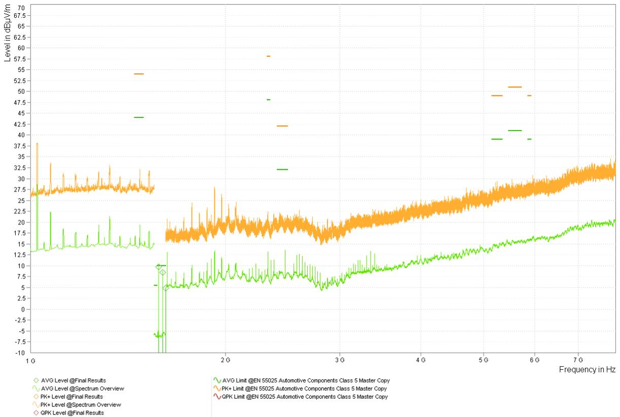
図 3-23. バリエーション 3 LMK3C0105 3.3V (-0.5%) スペクトラム概要 - ホーン
