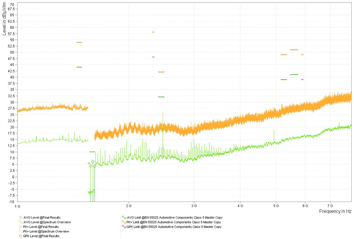
図 3-21. バリエント 2 LMK3C0105 3.3V (-0.5% SSC) スペクトラムの概要 - ホーン
