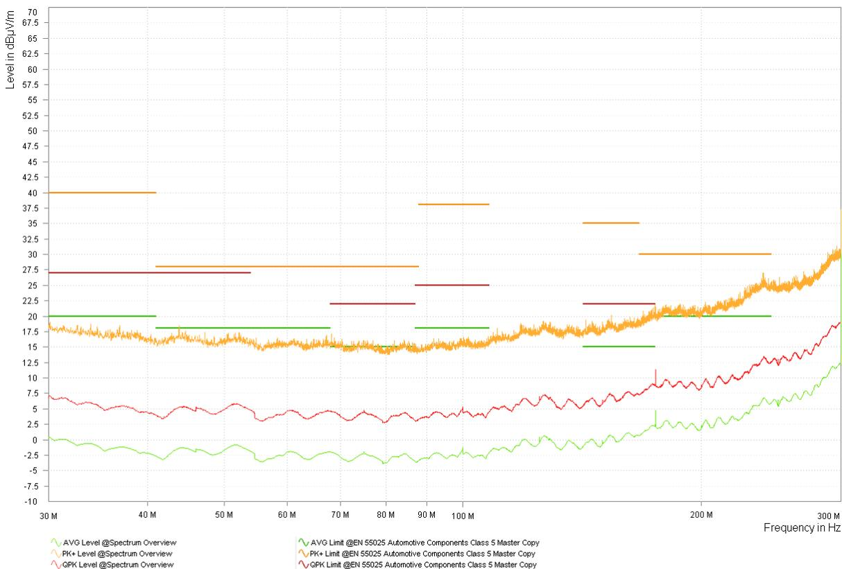
図 3-12. バリエーション 4 競合他社の発振器 3.3V スペクトラムの概要 - パイオニカル
