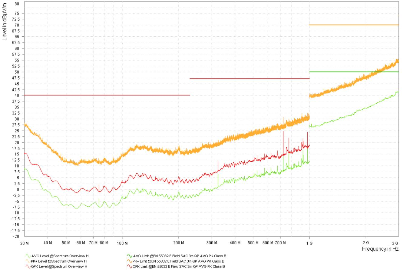
図 4-6. バリエント 3 LMK3C0105 3.3V Y 軸スペクトルの概要 - 水平
