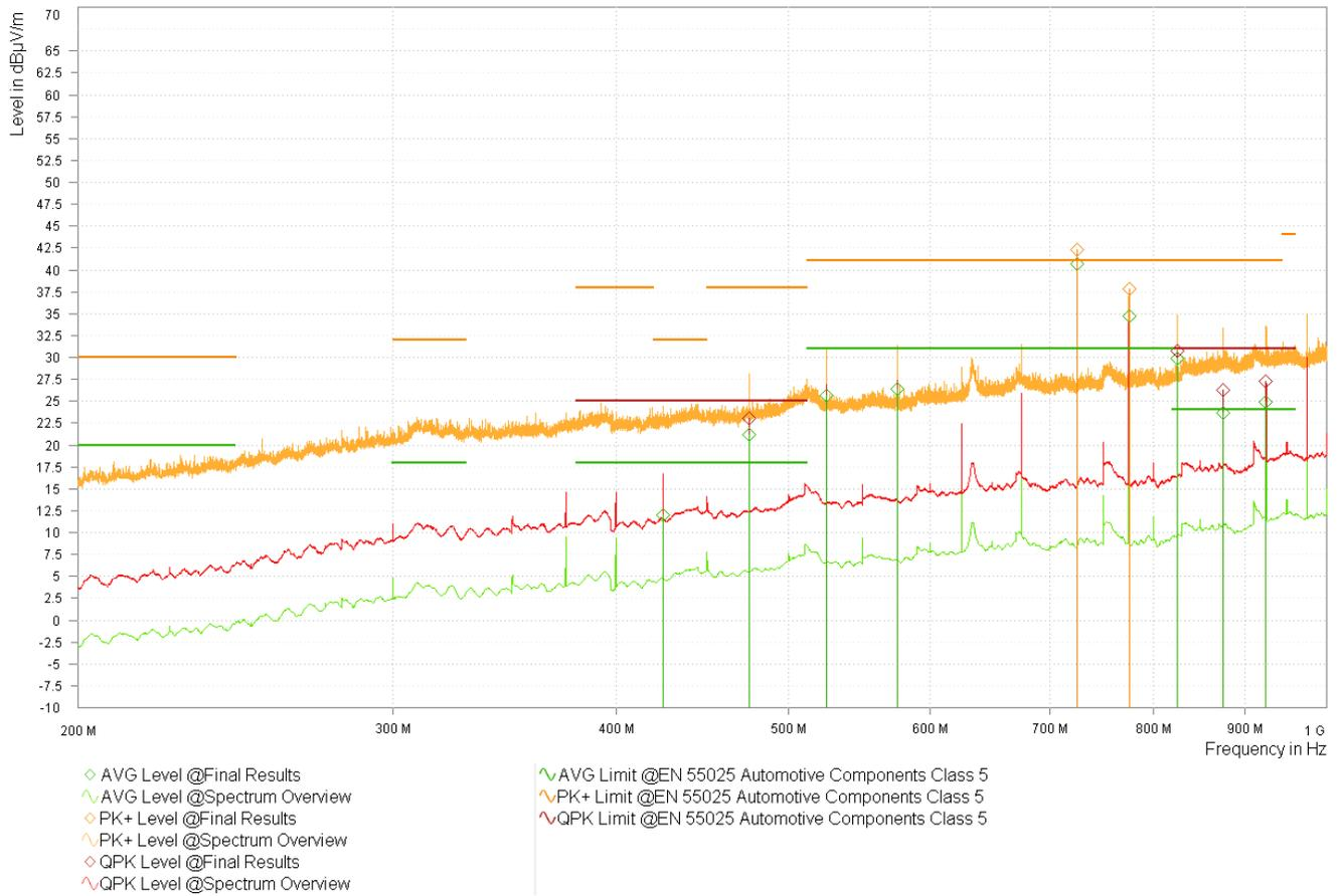
図 3-15. バリエーション 3 LMK3C0105 3.3V スペクトラムの概要 - 対数周期
