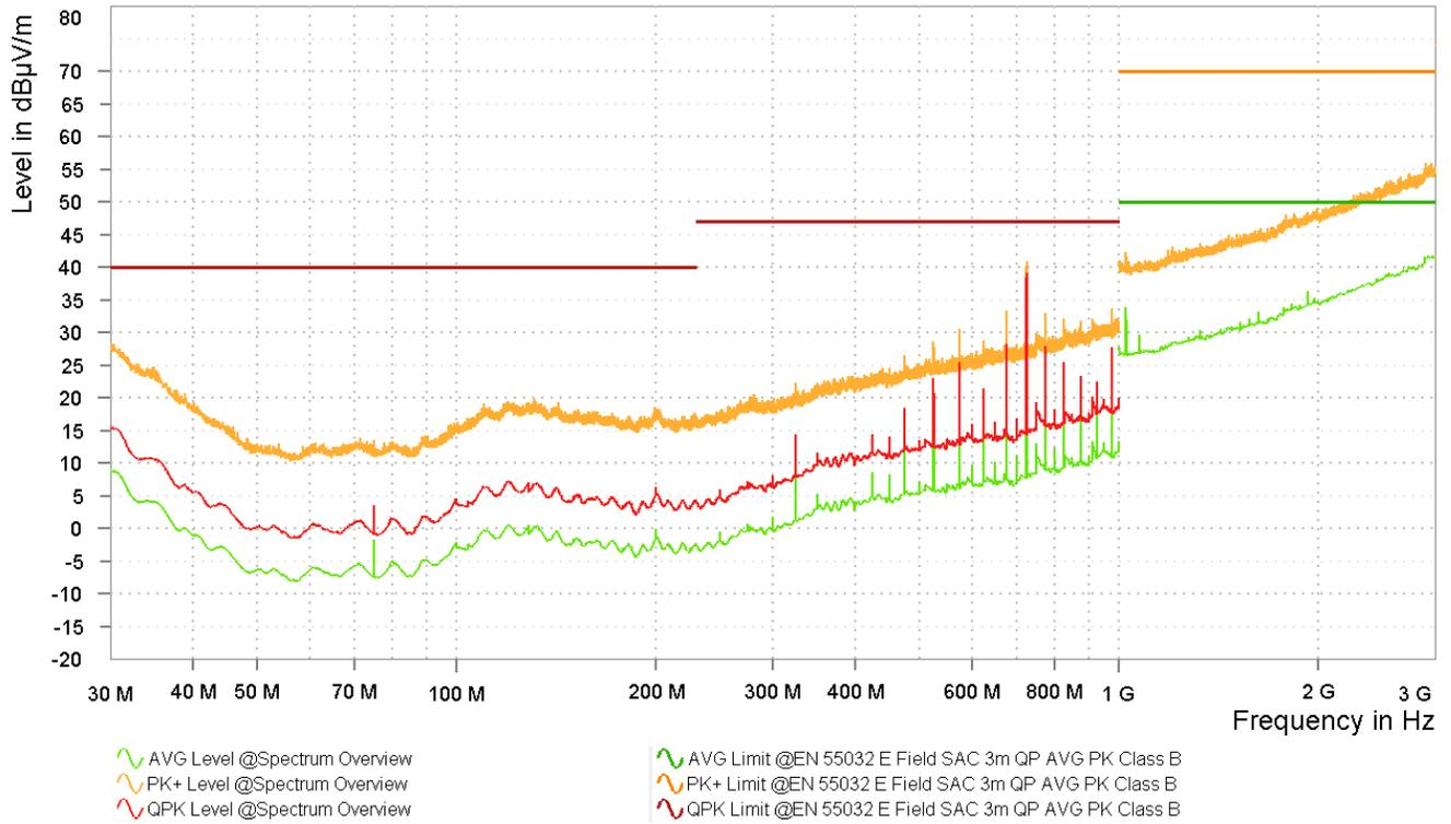
図 4-9. バリエント 3 LMK3C0105 3.3V Z 軸スペクトルの概要
