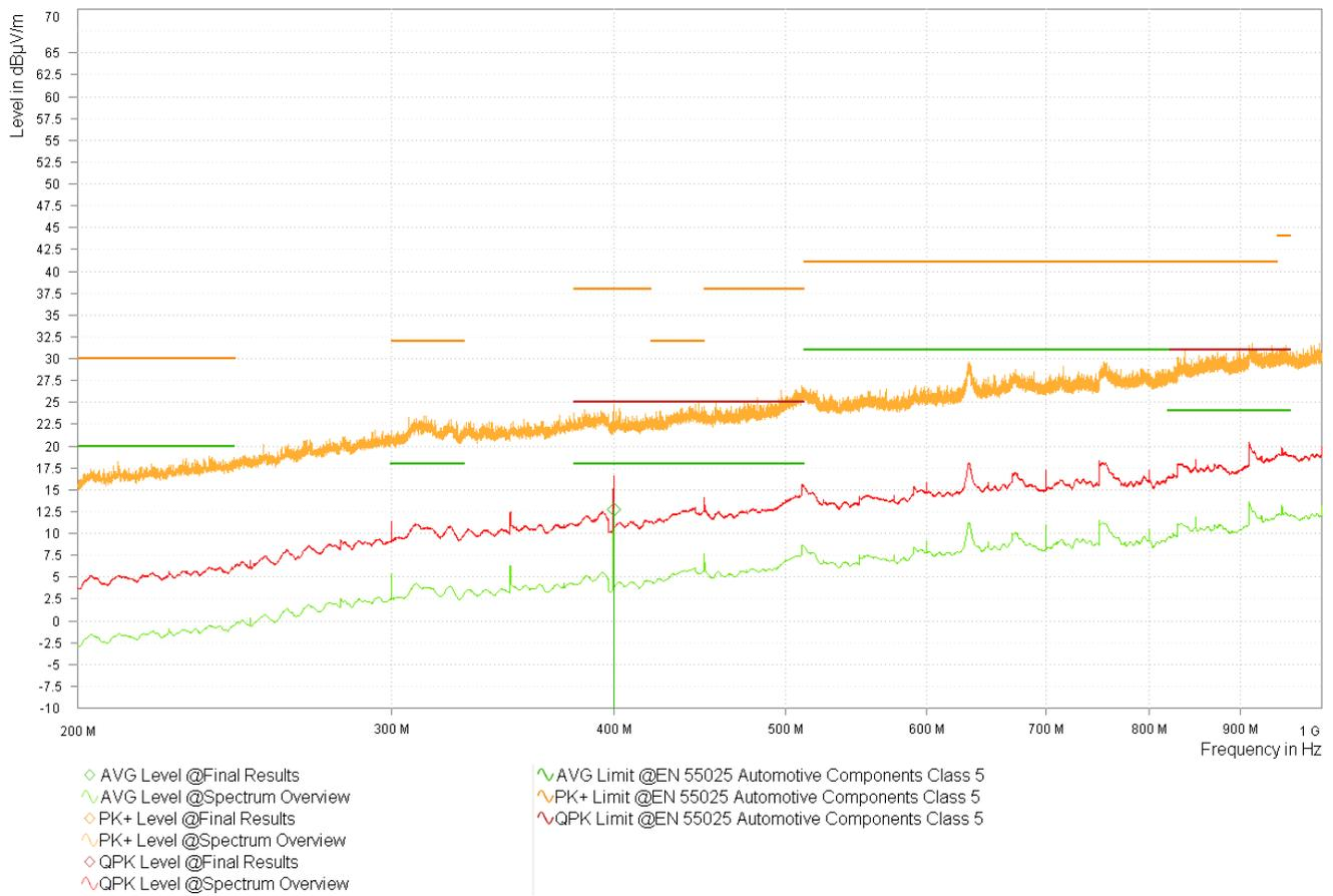
図 3-17. バリエント 1 LMK3C0105 1.8V スペクトラムの概要 - 対数周期
