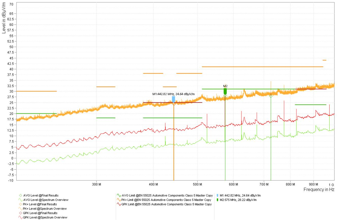
図 3-18. バリエーション 3 LMK3C0105 1.8V スペクトラムの概要 - 対数周期
