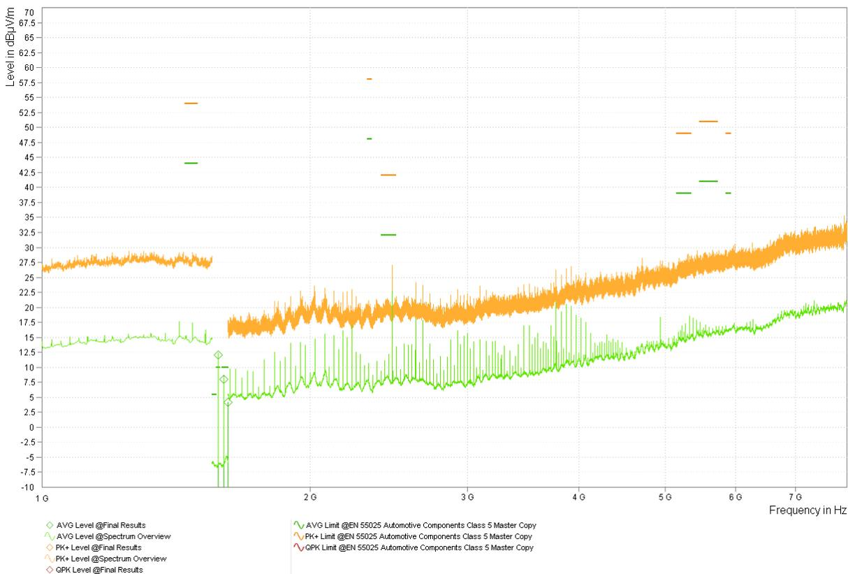
図 3-20. バリエーション 2 LMK3C0105 3.3V スペクトラムの概要 - ホーン
