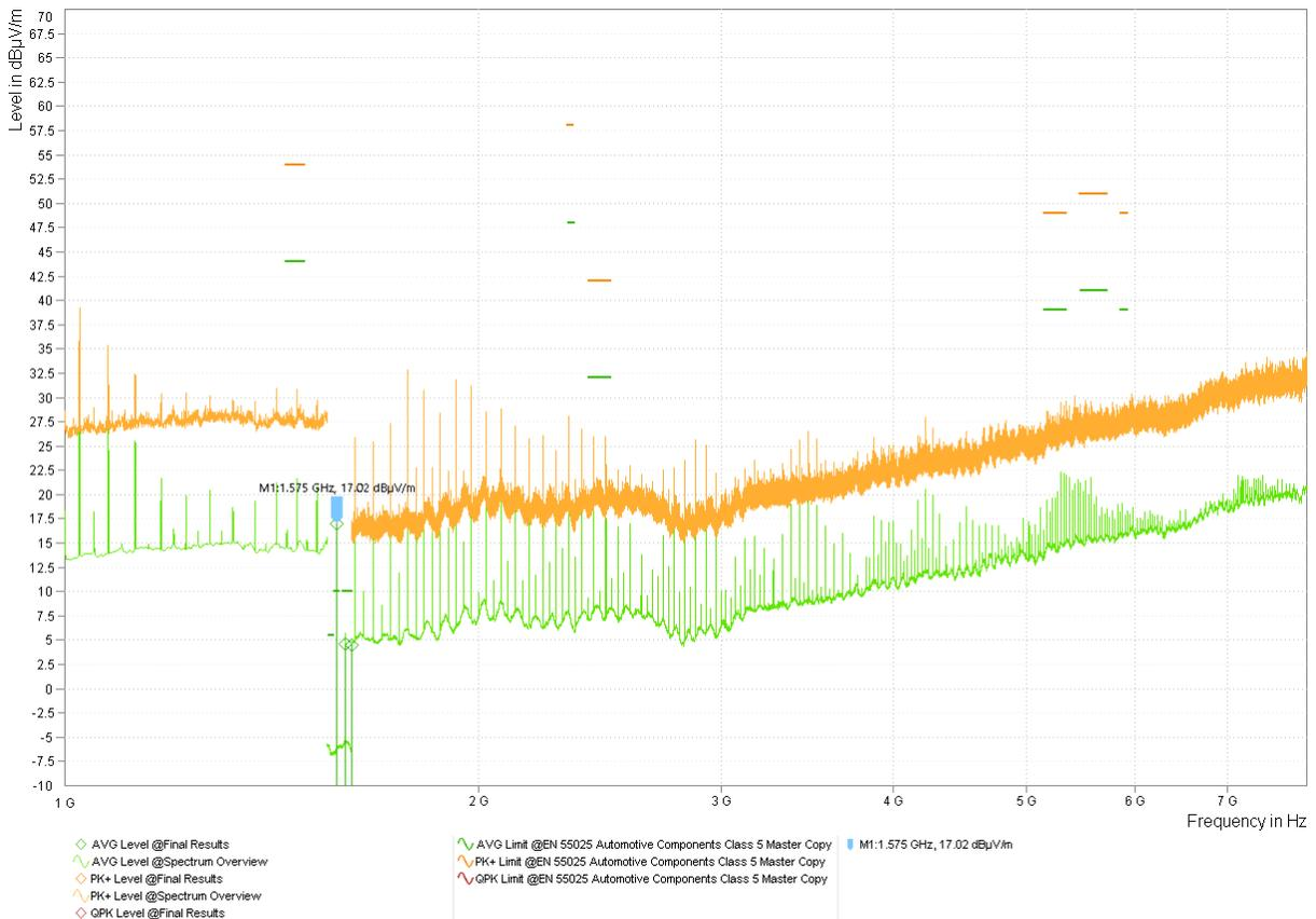
図 3-22. バリエント 3 LMK3C0105 3.3V スペクトラムの概要 - ホーン
