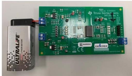
図 7. ISOW7741 の評価基板
