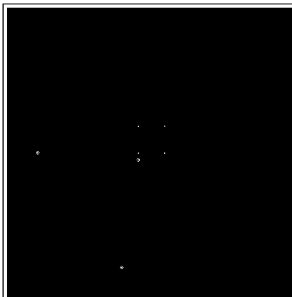
図 A-50. TLV755P (SOT-23) の JEDEC High-K 近似の内層 1
