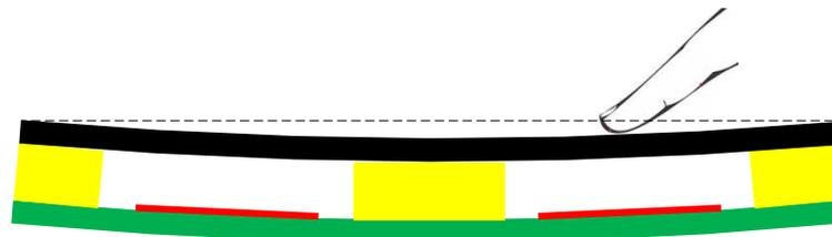
図 21. 機械的構造の剛性が不十分
