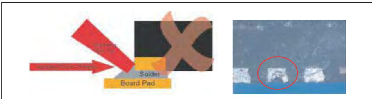
図 18. 手動リワークによる損傷
