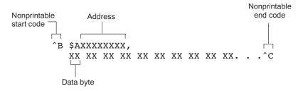
Figure 12-8. ASCII-Hex Object Format
