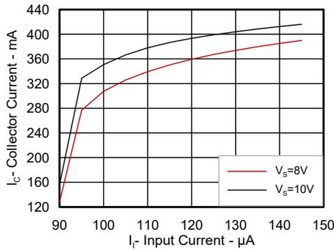
図 5-3. コレクタ電流と入力電流との関係
