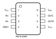
図 5-2. UCC5350SB-Q1 8-Pin SOIC Top View
