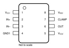
図 5-1. UCC5350MC-Q1 8-Pin SOIC Top View
