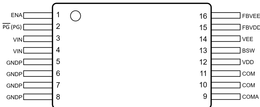
図 5-1. DHA パッケージ、16 ピン SSOP (上面図)
