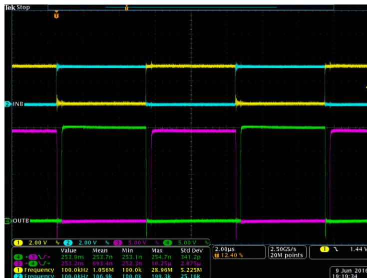
図 8-5. INA/B と OUTA/B のベンチ テスト波形
