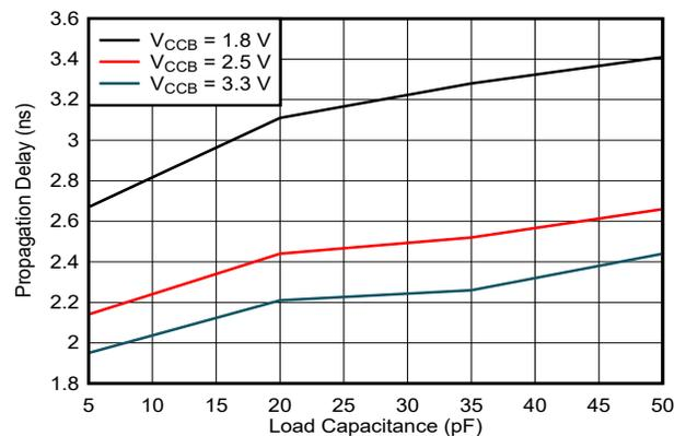
図 5-10. 伝搬遅延、 $T_{PHL}$  と負荷容量との関係 ( $V_{CCA} = 2.5V$ )
