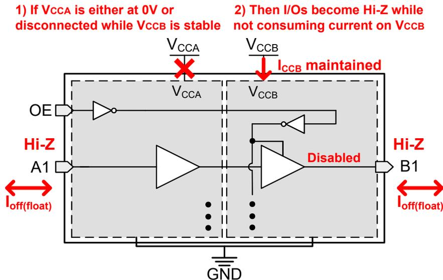
図 7-2.  $V_{CC}$  絶縁および  $V_{CC}$  接続解除機能
