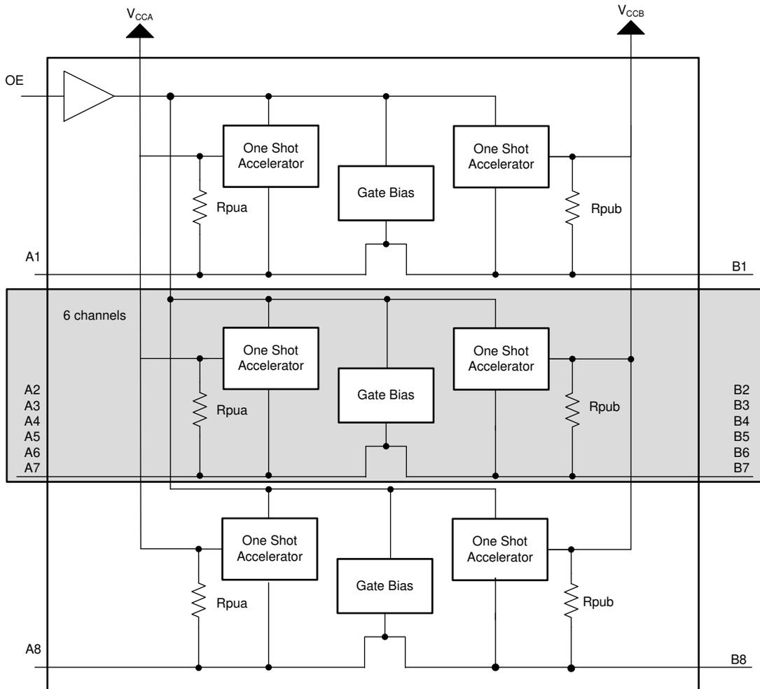
各 A ポート I/O には  $V_{CCA}$  へのプルアップ抵抗 ( $R_{PUA}$ ) があり、各 B ポート I/O には  $V_{CCB}$  へのプルアップ抵抗 ( $R_{PUB}$ ) があります。出力を Low に駆動すると、 $R_{PUA}$  と  $R_{PUB}$  の値は 40k $\Omega$  になります。出力を High に駆動すると、 $R_{PUA}$  と  $R_{PUB}$  の値は 4k $\Omega$  になります。OE = Low のときは、 $R_{PUA}$  と  $R_{PUB}$  はディセーブルになります。
