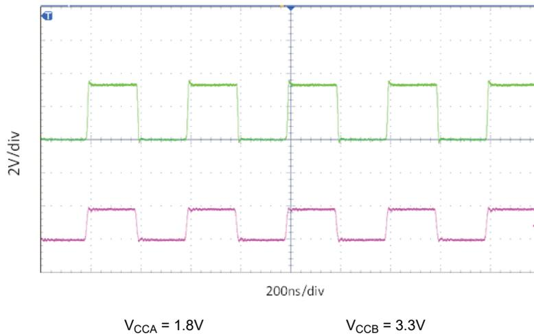
図 8-2. 2.5MHz 信号のレベル変換
