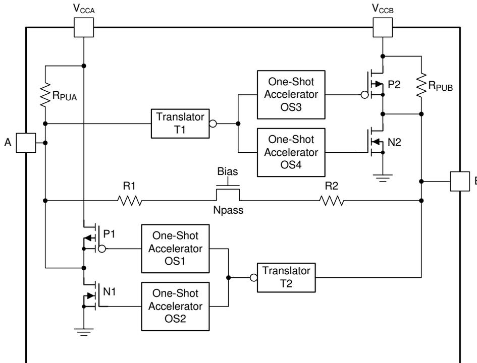
図 7-1. TXS0108E セルのアーキテクチャ
