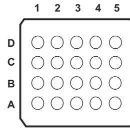
図 4-2. NME パッケージ、20 BGA (底面図)
