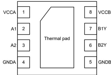
図 4-2. TXGx020DSG パッケージ 8 ピン WSON (上面図)
