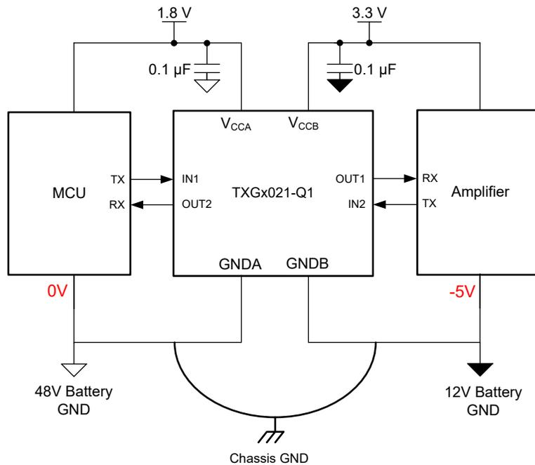
図 8-1. 車載用途での TXG1021-Q1
