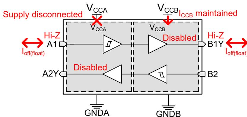
図 7-1. V<sub>CC</sub> 接続解除機能
