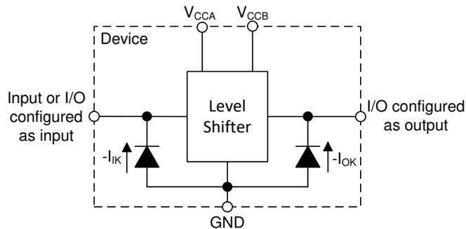
図 7-2. 各入力と出力に対するクランプダイオードの電気的配置
