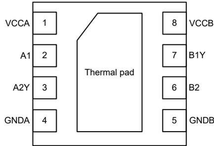
図 4-1. TXGx021DSG パッケージ 8 ピン WSON (上面図)
