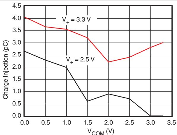
图 5. Charge Injection ( $Q_C$ ) vs  $V_{COM}$
