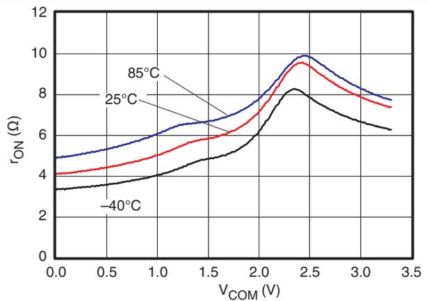
图 2.  $r_{ON}$  vs  $V_{COM}$  ( $V_+ = 3.3$  V)
