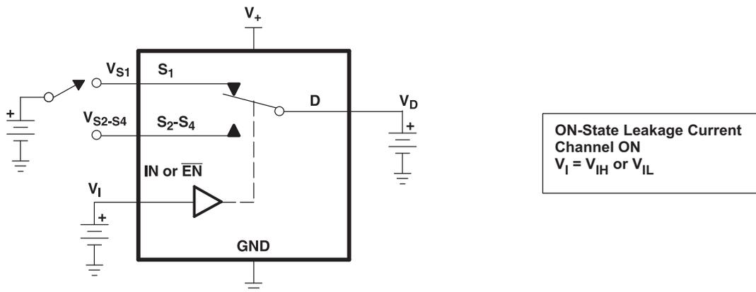
图 14. ON-State Leakage Current ( $I_{D(ON)}$ ,  $I_{S(ON)}$ )
