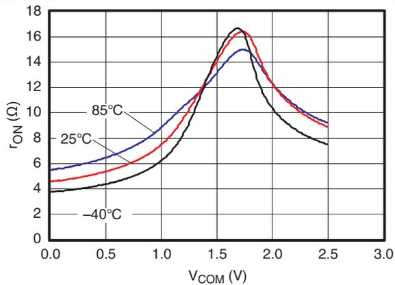
Figure 3.  $r_{on}$  vs  $V_{COM}$  ( $V_+ = 2.5$  V)
